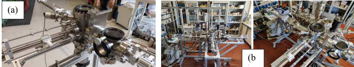
Figura 8: (a) Il sistema completo con camera di deposizione e camera di load/lock presso Ionvac Process S.r.l. (b) Vista di insieme del sistema completo dalla sorgente ESI alla camera di deposizione assemblato presso i laboratori del CNR-ISM a Montelibretti.
