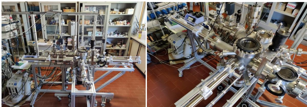
Figura 23 : La camera di deposizione accoppiata al set-up del CNR-ISM a Montelibretti.
