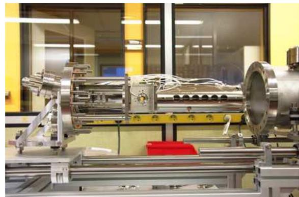
Figura 16: La seconda sezione dell'apparato con le due componenti: quadrupolo e deflettore elettrostatico.
