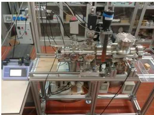
Figura 15: La prima parte del set-up in cui il fascio ionico è immesso in vuoto e guidato dall'ottupolo. Nella configurazione mostrata sopra dopo la valvola si è connessa la camera provvisoria per studiare la deposizione in alto vuoto (vd. Attività 3.3)
